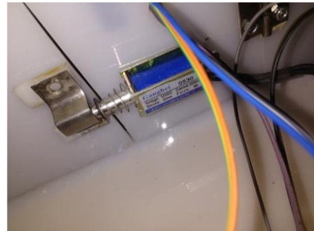
Gambar 2. Solenoid dalam posisi lock
