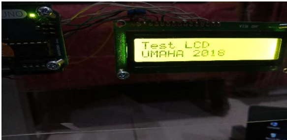
Gambar 28. Hasil Pembacaan Arduino Ke LCD 16x2
