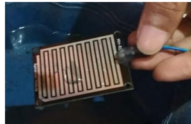
Gambar 11. Sensor Ditetesi Air
