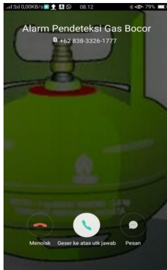
Gambar 17. Hasil monitoring pengujian fitur call gateway pada smart phone .
