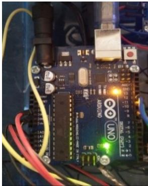
Gambar 14. Tampilan Pemasangan board arduino uno
