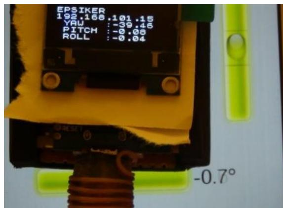
Gambar 5. Kalibrasi menggunakan *waterpass*.
