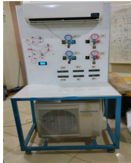
Gambar 2. Foto Alat peraga mesin pendingin AC split
