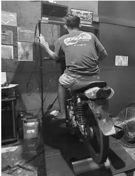
Gambar 2 Pengujian torsi dan daya mesin
