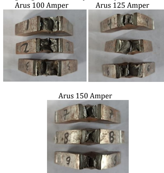
Gambar 11. Spesimen Setelah Uji Impak
