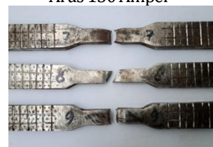
Gambar 7. Spesimen Setelah Uji Tarik
