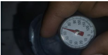
Gambar 8. Pengukuran suhu air 70°C
