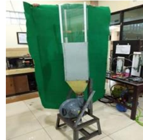
Gambar 8. Hasil Proses Perakitan Mesin Konveksi Paksa
