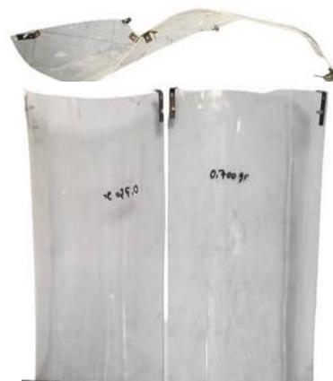
Gambar 4 Penampang blade terbuat dari bahan akrilik
