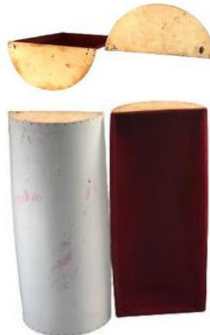
Gambar 3 Penampang blade dari bahan triplek
