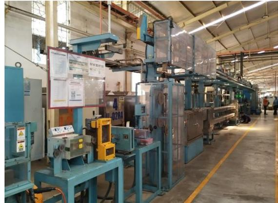
Gambar 4. Mesin *extruder*
