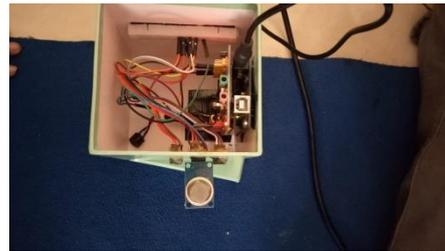
Gambar 9. Uji coba sensor asap
