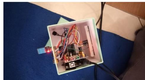
Gambar 8. uji coba Rangkaian Suhu
