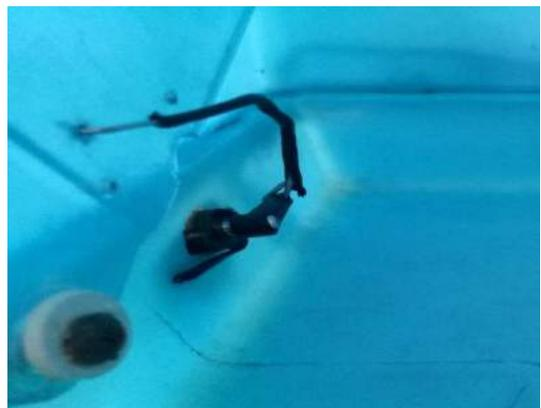
Gambar 14. Implementasi Motor Servo Dari Dalam
