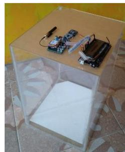
AMAN, kemudian jika ketinggian  $\leq 24$  cm dari sensor *Ultrasonic* maka akan otomatis mengirimkan status ketinggian air melalui SMS dengan status di LCD ketinggian air *SIAGA*. Untuk peringatan berupa bunyi beep *buzzer* dan SMS sistem akan mengirim peringatan ketika ketinggian air mencapai  $\leq 10$  cm atau lebih dari sensor *Ultrasonic*. Pada LCD akan menampilkan status "BAHAYA".
