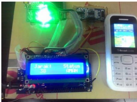
Gambar 7. Pengujian SENSOR HC-SR04 saat sistem bekerja
