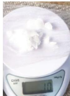
Kostik, merupakan bahan campuran untuk pewarna naphthol. Tanpa kostik pewarna naphthol tidak dapat meresap dan menempel pada kain, sehingga ketika dicelupkan pada pewarna garam hasilnya kurang maksimal dan terbilang rusak.
