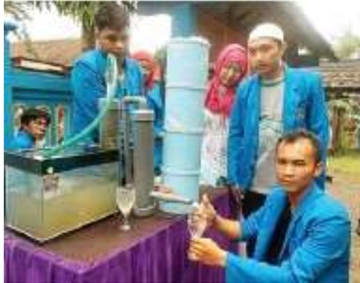
Gambar 3. Penjernih air sederhana dengan peralatan rumah tangga yang tidak terpakai
