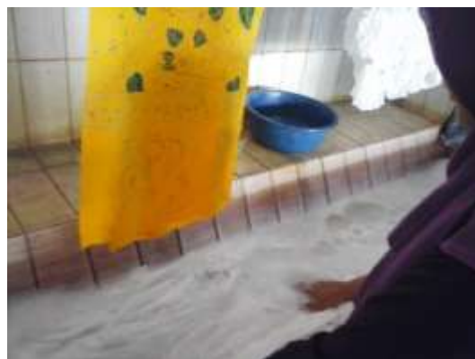
Gambar 4. Proses merendam kain dalam larutan turkish red oil (TRO), guna untuk membuka serat kain supaya warna dapat menyerap dengan baik. (Dokumentasi pribadi, 29 November 2016)
