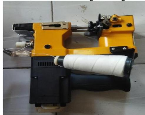
Gambar 4. Mesin untuk menjahit karung
