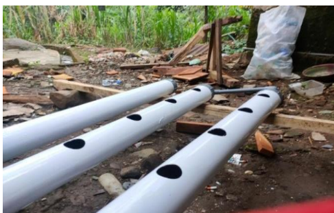
Gambar 2. Pembuatan pipa instalansi hidroponik
